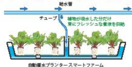
スマートファームを使った植物工場は底面灌水で植物が吸収して底面の不織布が乾くと養液を供給するシステムです。プランター側面のタンクから常にフレッシュな養液を与えるだけです。排水する必要が無く経済的で、環境に悪影響を与えません。
